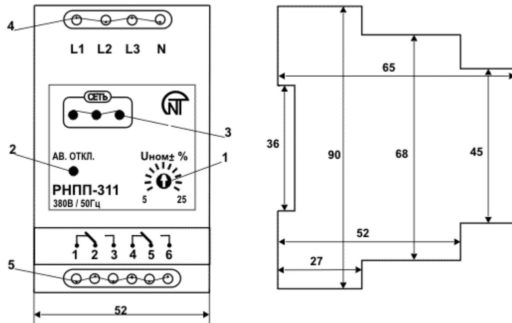
1. Регулировка срабатывания по  $U_{max}/U_{min}$
