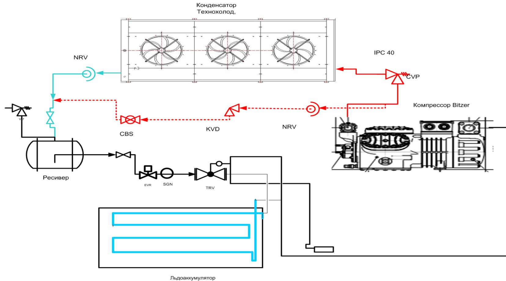
Схема ГЛВ с системой зимнего пуска
