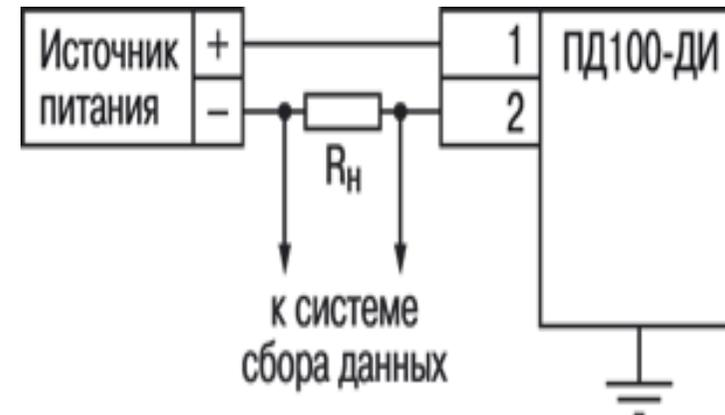
Параметры для частотного преобразователя, при работе с преобразователем давления типа ПДИ-100 ДИ ( 0-6 кг/см<sup>2</sup>, 4 -20 мА)
